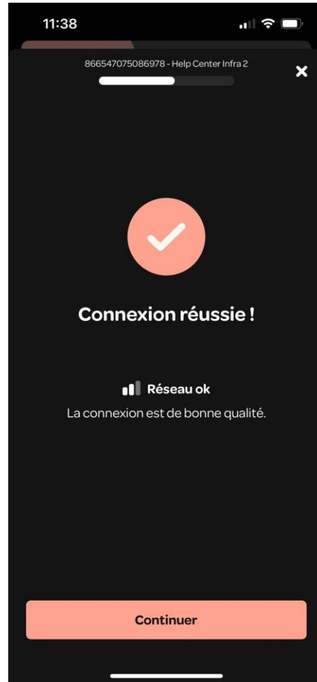
Après l'insertion des piles, la LED du Check'In Infra 2+ va clignoter **lentement en blanc**. Cela signifie que le Check'In Infra 2+ est en train de rechercher du réseau. Une fois la connexion établie, tapez sur « **Continuer** ».
